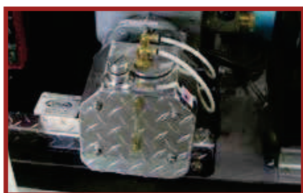
Sistema de vacío con bomba Conde
