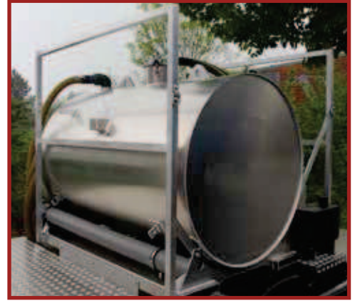
Barras de protección
