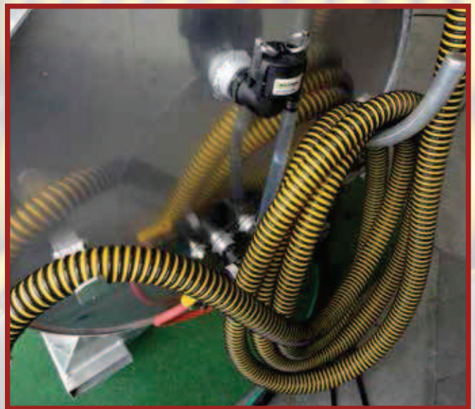
Manguera de servicio / succión (La barra de apoyo única para la manguera de servicio reduce significativamente la necesidad de un enrollador de manguera caro)
