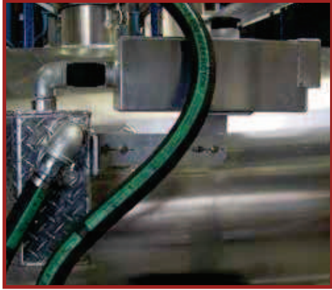
Envase de vaporizador de perfume conectado al silenciador
